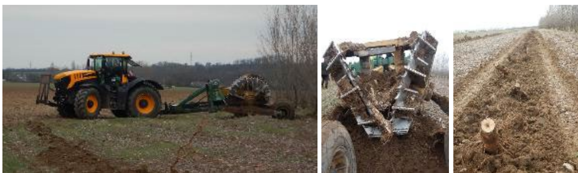
Obrázek 9. Vytrhávač pařezů Savannah 1720 při polních testech na JZ Slovensku (pro IKEA SK).
