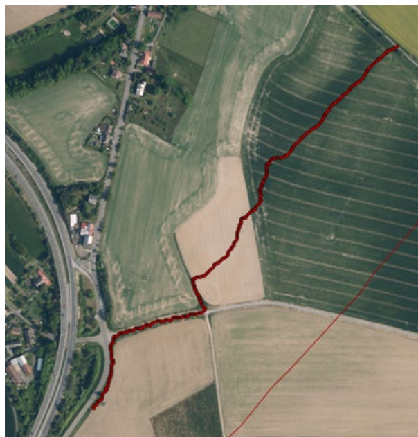
Obrázek 18. Červeně jsou uvedeny KBK na dráze povrchového odtoku, kdy je znatelné vybělení okolních svahů oproti údolnici. Území ORP Jablonec, Žďárek
