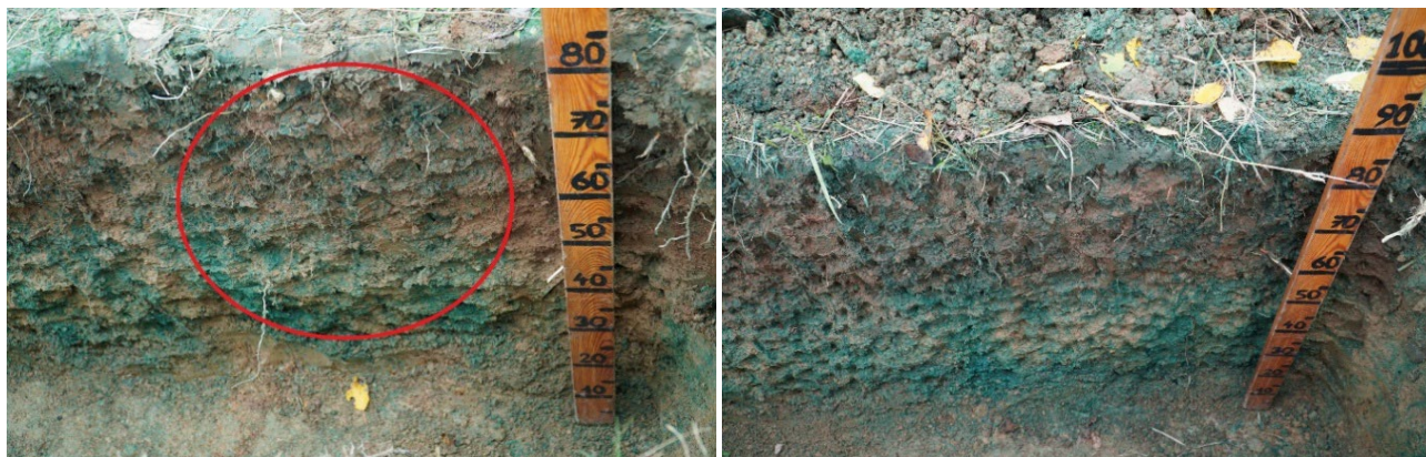
Obrázek 34. Výrazné prokořenění dřevin a trav v půdě agrolesnického pásu RRD (vlevo) přispělo k intenzivní infiltraci vody s barvivem do hlubších vrstev; vpravo je pak zřejmý přechod půdních horizontů a akumulace stopovací látky ve větší hloubce (foto Kincel).
