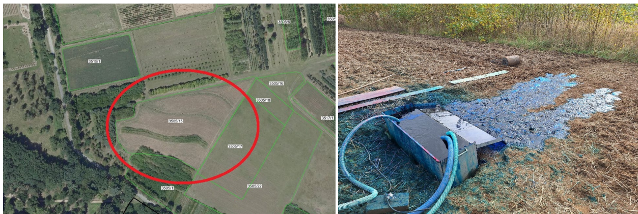
Obrázek 32. Ortofoto pokusného porostu (MichALS-2, vlevo) a přelivný zavlažovací žlab s vodou se stopovačem
